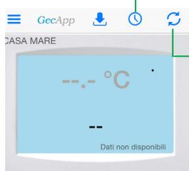
Effettuata una delle due operazioni, attendere l'invio dell' **SMS** e la risposta da parte del **GecApp Crono** (scritta **SMS** sul display).
